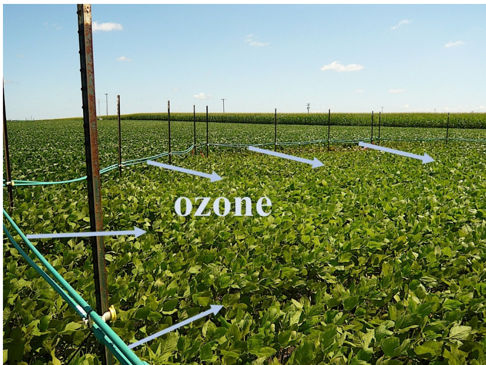
写真1 植物へのオゾンの影響を野外(写真はダイズ畑)で研究する施設。畑を取り囲むパイプに開けられた小孔から、高濃度オゾンが放出される(矢印)。(撮影: 及川真平)
