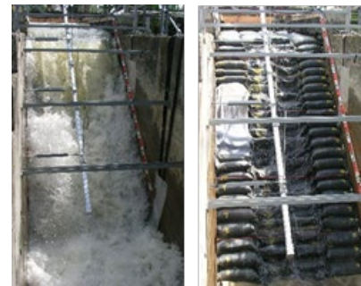
図4ab 土のう積層堤体の洪水実験の様子 5)
