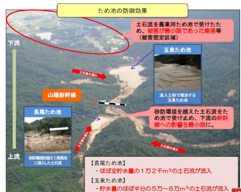
図2 ため池による洪水防止の事例 4)
