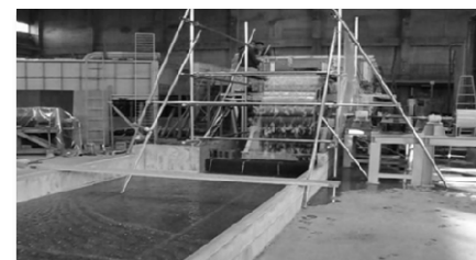
水車通水試験状況
