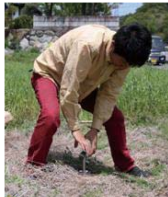
図7.4 土壌サンプラーによる採取
