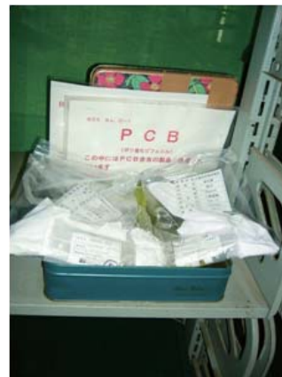
使用済みPCB付着廃棄物保管状況
