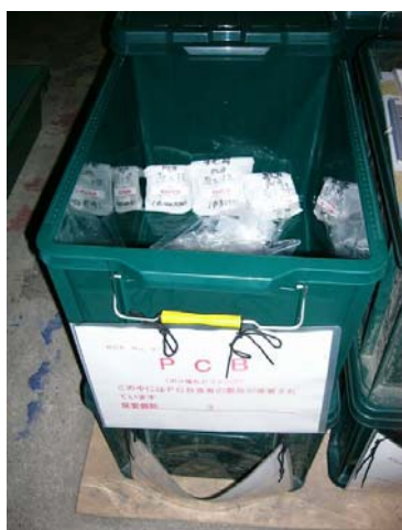
写真 10-5-2 安定器保管状況
